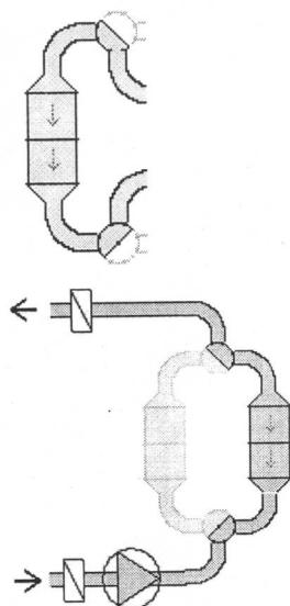
Ёмкость с адсорбентом, регенерация которого производится в данный момент, представляется с помощью стрелки.
