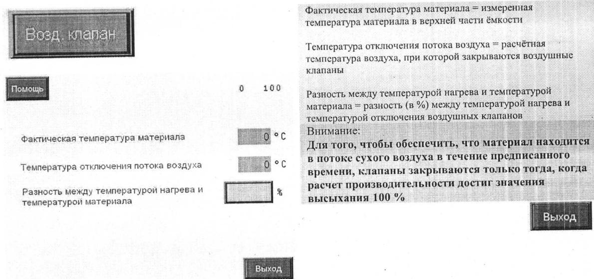
Ввод значения разности (в процентах), при котором должны закрываться воздушные клапаны
