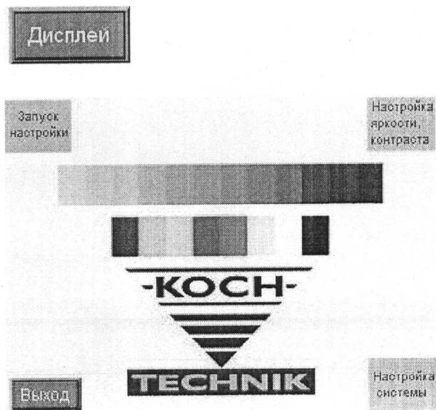
Последовательным нажатием кнопок Start – Helligkeit – Start («Старт – Яркость – Старт») или Start – System – Start («Старт – Система – Старт») вызываются основные настройки дисплея.
