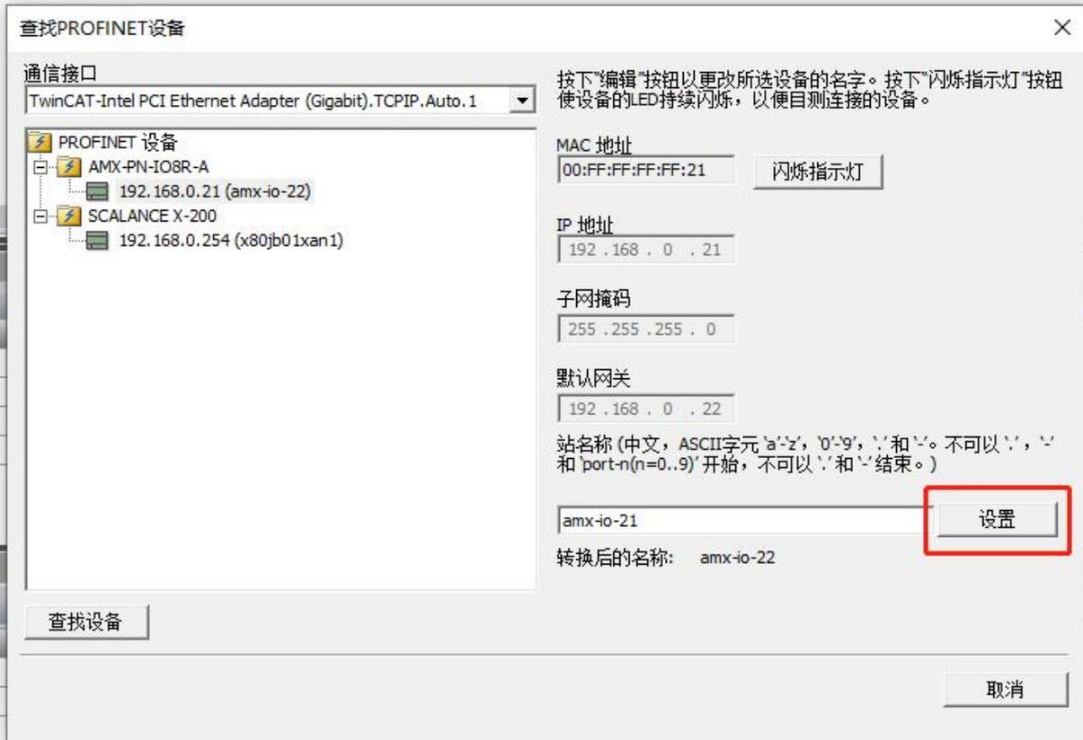
下载完成后，在组态时设置模块对应 IP，在程序下载后会修改模块对应 IP 地址，设置组态时 IP 详见第 5.3 小节。
