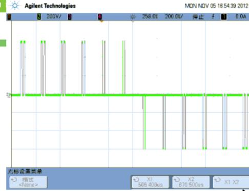
驱动器输出的脉冲电压波形
