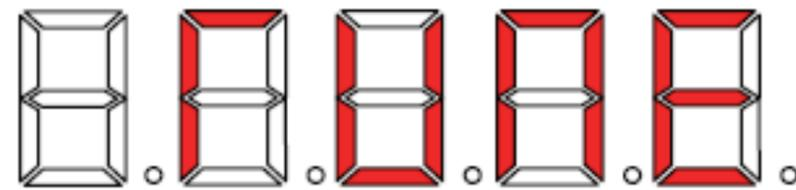
4. 按下面板上的RUN键，变频器自动运行进行调谐，右上角TUNE灯闪烁。等待2~3分钟后，面板显示退回正常时表示调谐完成，将bF.04改为1。
