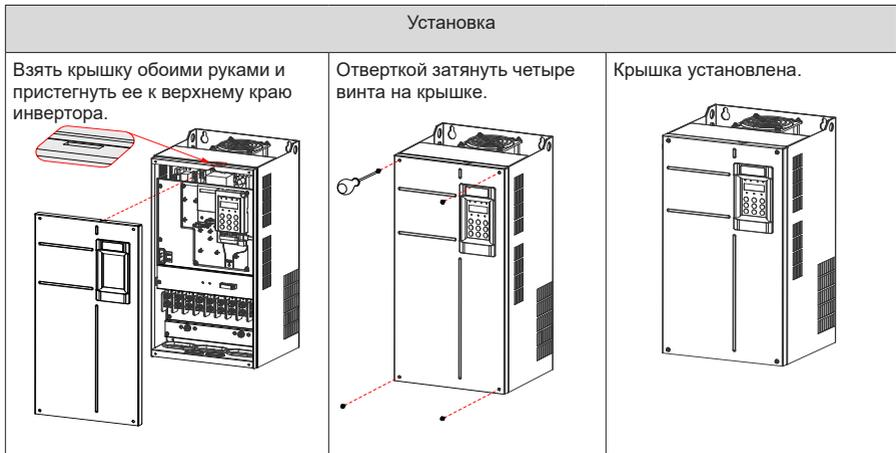
Рис. 3-24 Снятие и установка крышки моделей мощностью 45 – 160 кВт
