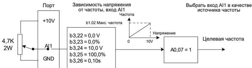
Рис. 5-7 Использование аналогового входа для установки задания частоты
