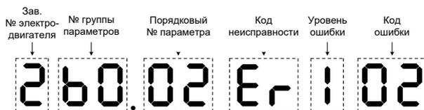
Рис. 4-2 Пример отображения данных на светодиодном дисплее
