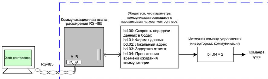
Рис. 5-3 Пример управления инвертором посредством коммуникации с хост-контроллером
