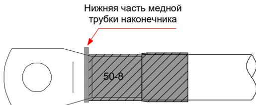
Рис. 3-36 Термоусадочная трубка, закрывающая жилу кабеля
