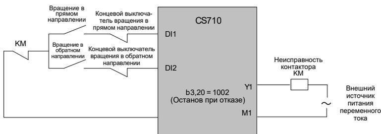
Рис. 5-10 Цепь предела безопасности и останова при отказе
