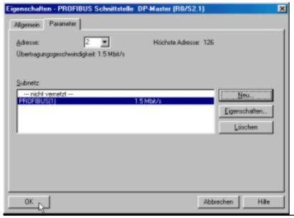
Nach Betätigen der Schaltfläche "OK" wird das Subnetz eingefügt. Als nächstes muß die zuvor erstellte GSD-Datei installiert werden.
