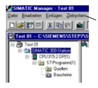
Laden Sie anschließend das SPS Programm in Ihre Baugruppe. Unter dem Menüpunkt "*Zielsystem*" befindet sich dazu der Befehl "Laden".
