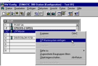
Fügen Sie jetzt das DP-Mastersystem ein. Markieren Sie dazu das Feld DP-Master, und klicken Sie die rechte Maustaste an. Durch ein weiteres Anklicken des Menüpunktes DP-Mastersystem einfügen öffnet sich das Fenster "Eigenschaften - Profibus Schnittstelle DP - Master".
