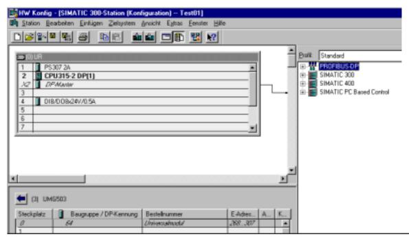
Der nächste Schritt ist das Einfügen der Meßgeräte in das DP Mastersystem. Gehen Sie dazu im Katalog in den Ordner Profibus DP. Unter Feldgeräte "Sonstige" befindet sich das durch die GSD-Datei installierte UMG 503.
