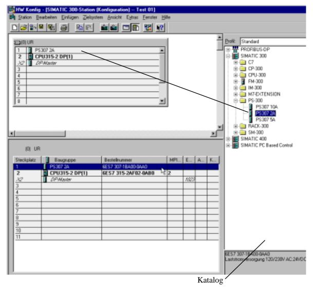
Im Hardwarefenster ordnen Sie den einzelnen Komponeten, wie CPU, Stromversorgung, Digitaleingabe-Ausgabekarten den richtigen Steckplatz zu. Blenden Sie dazu den Katalog auf der rechten Seite ein. Benutzen Sie dazu den Menüpunkt "Ansicht Katalog". Um einer Komponente wie z.B der Stromversorgung einen Steckplatz zuzuordnen, markieren Sie zunächst die Komponete im Katalog, und ziehen Sie die Komponenten anschließend mit der Maus auf den entsprechenden Steckplatz.
