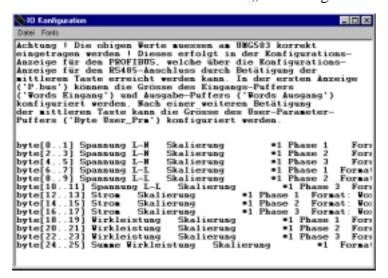
Speichern Sie die I/O Konfiguration zunächst als Text-Datei ab oder drucken Sie die Konfiguration aus. Die Daten benötigen Sie später für die Zuordnung der Meßwerte zum Adressbereich. Schließen Sie das Fenster wieder, und exportieren Sie anschließend die GSD-Datei. Schließen Sie nach dem Exportieren der GSD-Datei das Programm.
