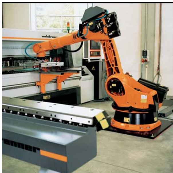
Рис. 2-12: Манипулирование листовыми деталями – гибка листов
