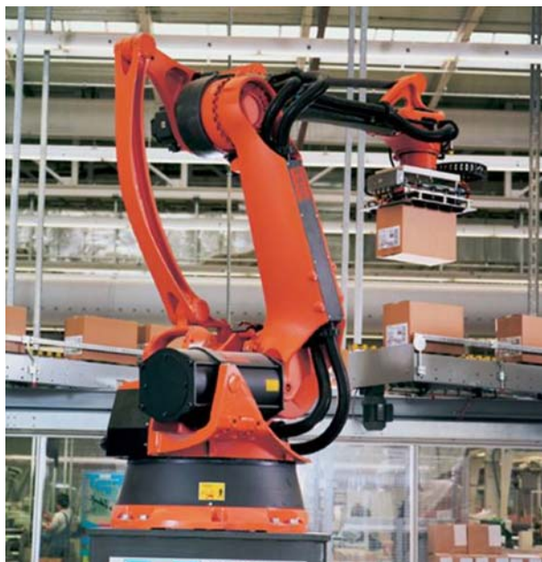
Рис. 2-20: Палетирование картонных коробок
