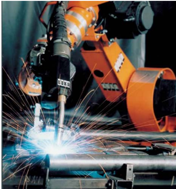
Рис. 2-8: Сварка в среде защитного газа
