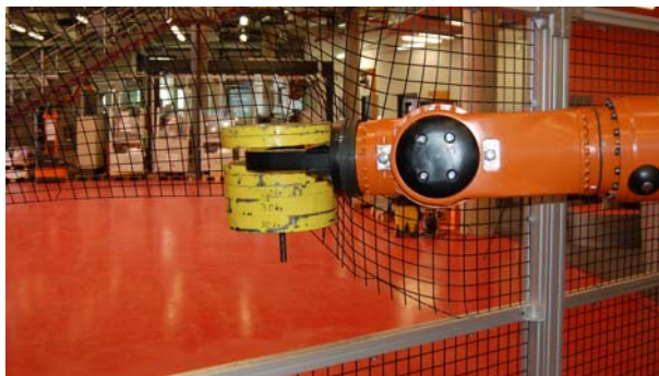
Рис. 3-14: Повреждение защитного ограждения
