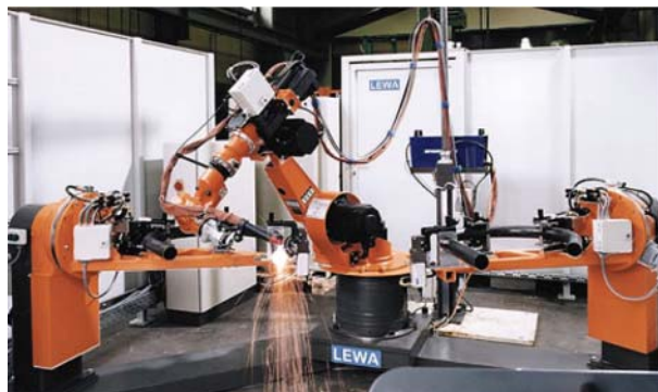
Рис. 3-6: Сварная секция для сварки в среде защитного газа с внешней системой подачи энергии
