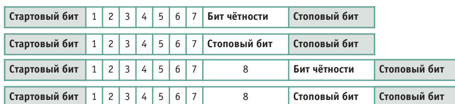
Рис. 2. Структура кадра для 7-битового режима ASCII и 8-битового режима RTU с битом чётности или без него
