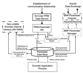
Figure 6-3 Encoder parameter control
