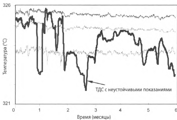
Рис. 4.13. Неустойчивые показания ТДС первого контура теплоносителя на АЭС с реактором типа PWR, предшествовавшие выходу датчика из строя
