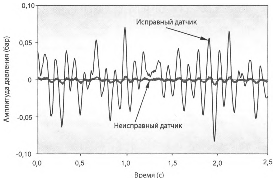
Рис. 9.13 Сигналы шума от исправного и неисправного датчиков Rosemount, полученные при испытаниях на работающей АЭС
