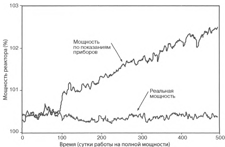
Рис. 1.6. Пример результатов мониторинга в режиме on-line для обнаружения загрязнений расходомеров Вентури
