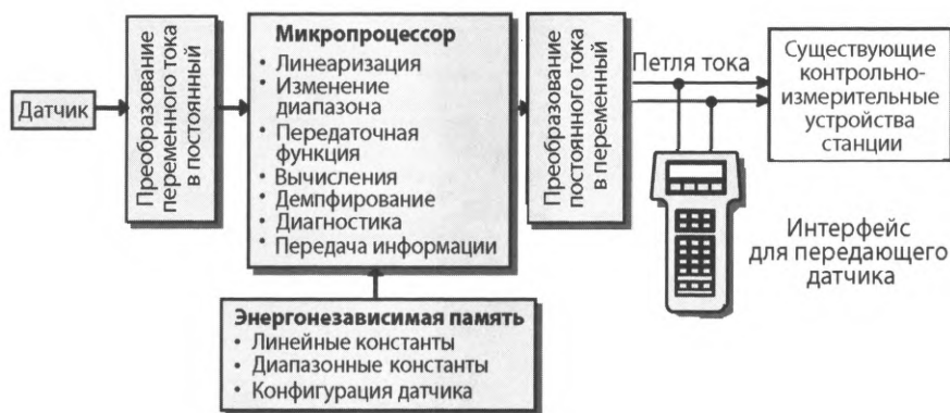
б) Типичные компоненты «умного» датчика
