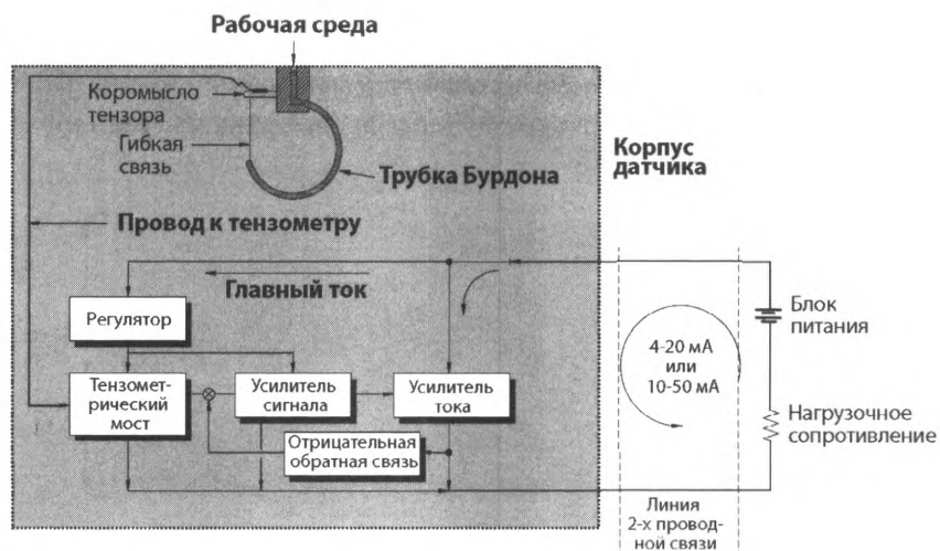
Рис. 7.12 Схема датчика давления фирмы Barton, модель 753
