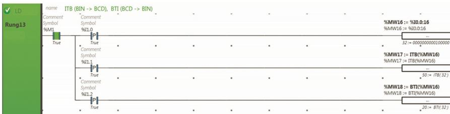
Рис. 7.27. Инструкции ITB\_BTI
