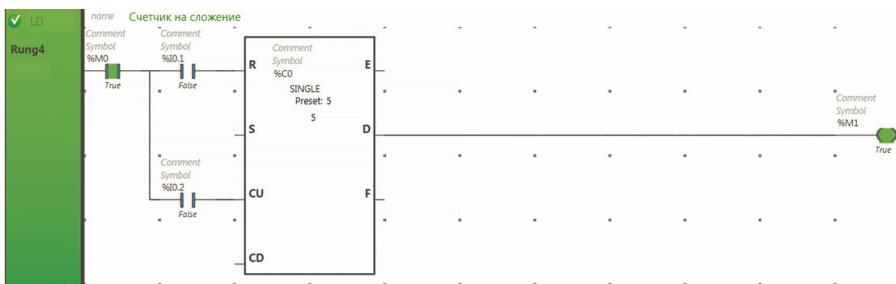
Рис. 7.21. Счетчик на сложение
