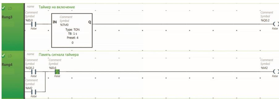
Рис. 7.20. Таймер на включение TON
