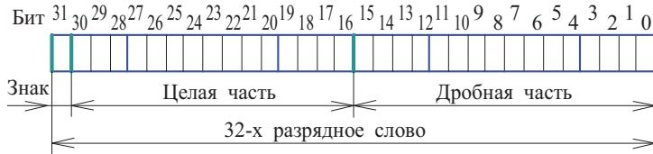
Сложение, вычитание, умножение и деление чисел с фиксированной запятой можно выполнить на компьютере так же, как с обычными целыми знаковыми числами, представив их в виде дробей с числителем и знаменателем и выполнять по классическим формулам.
