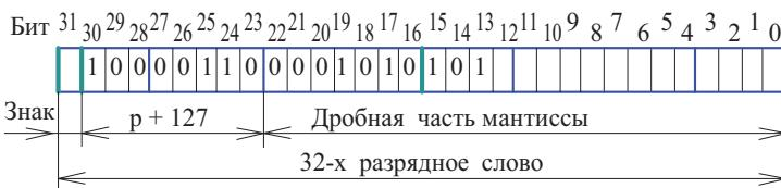
Дробная часть мантиссы числа с плавающей точкой хранится в двоичной системе счисления. Поэтому числа, которые точно записываются в десятичной системе счисления, в двоичной системе можно представить только в виде бесконечной дроби, которая в памяти компьютера хранится с ограниченной точностью.
