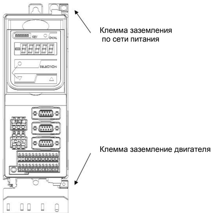
Рис.12. Расположение клемм заземления
