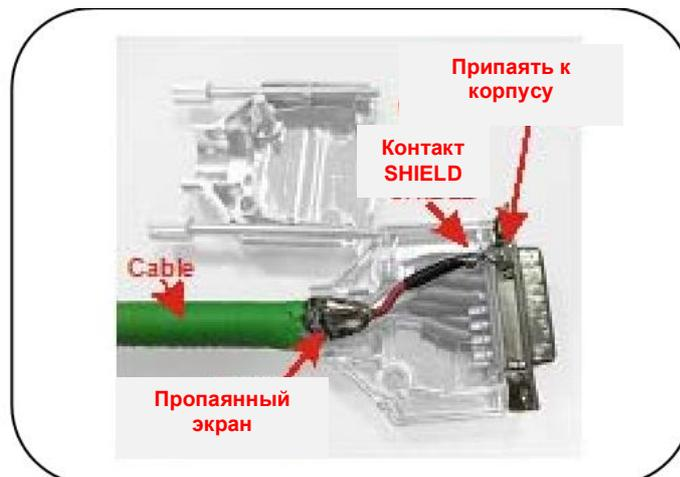
Рис.2. Присоединение экрана на разъеме
