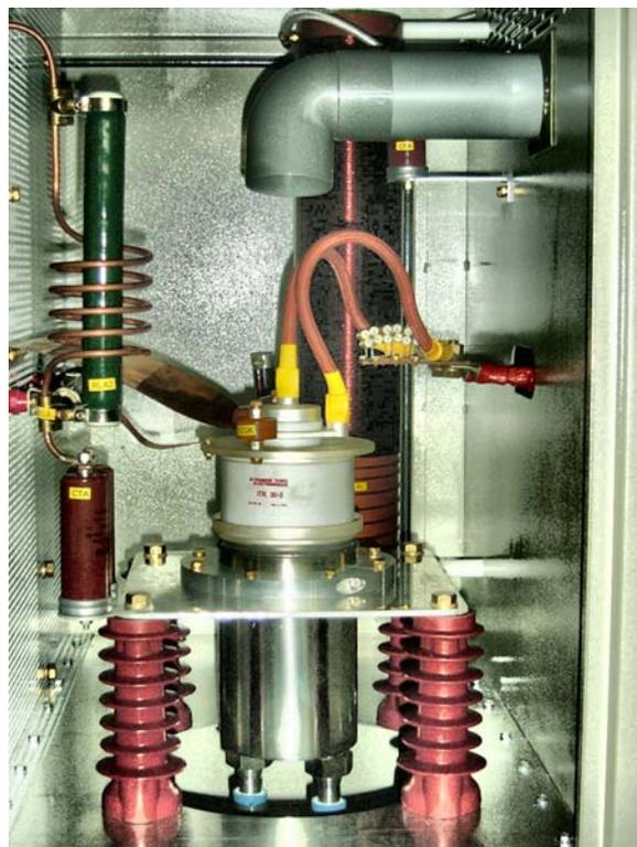
Figura 7.4.5g: a sinistra montaggio triodo per generatore compatto, a destra per generatore monoarmadio piccolo
