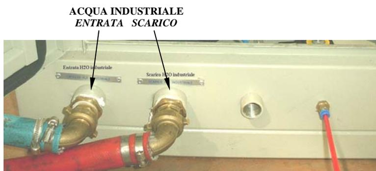
Figura 7.4.3a: attacchi circuito acqua industriale generatore compatto
