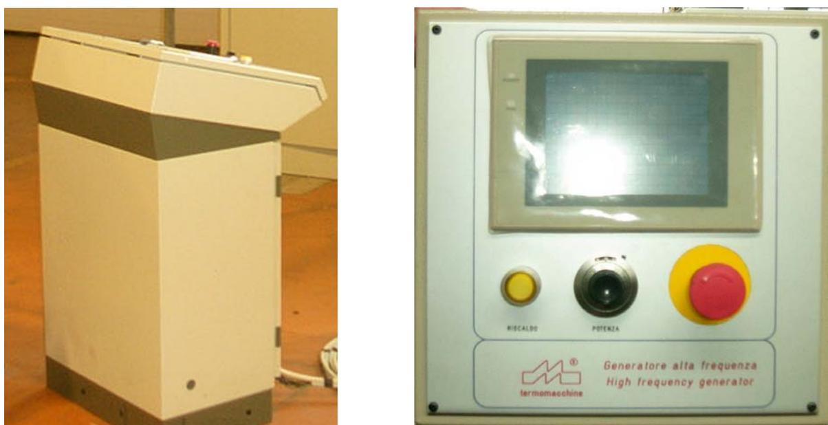
Figura 4.1.c: a sinistra esempio di pulpito comandi grande, a destra di uno piccolo.
